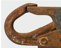
Corrosion / cracks / nicks / gouges
