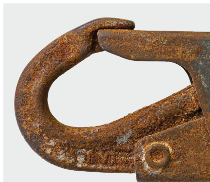
Corrosion / cracks / nicks / gouges
